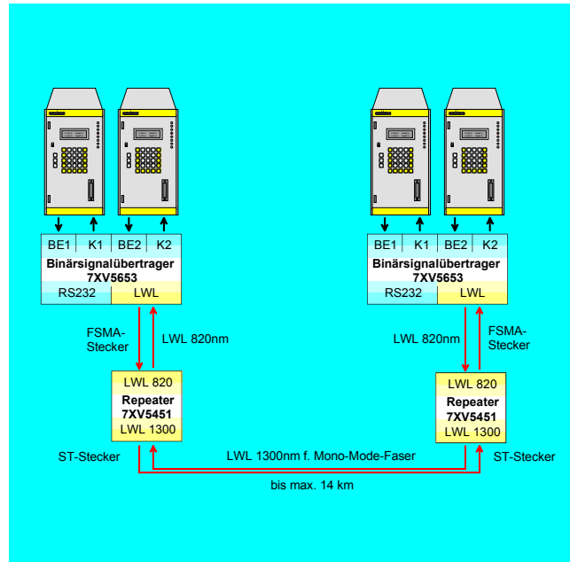
Bild 2: Binärsignalübertragung bis 14 km
