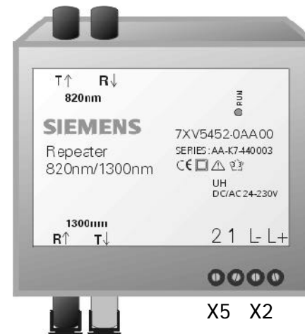
Abb. 1: Lage und Belegung der Anschlußklemmen
