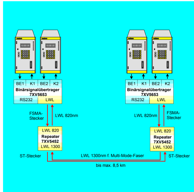
Bild 2: Binärsignalübertragung bis 8,5 km
