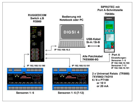
Hinweis: Das Netzwerk muss auf die Geräte beschränkt sein, die direkt mit dem Universal Relais kommunizieren. Das kann ein eigenes Netzsegment sein, oder ein getrenntes V-LAN-Segment. Die gleichzeitige Bedienung des Schutzgerätes (z.B. 7SK80x) mit DIGSI 4 ist zulässig.
