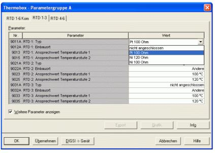
In diesem Menü kann für den Messwert "RTD 1" ein "Einbauort" ausgewählt werden.
