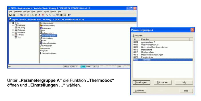
Im Folgenden werden dem Schutzgerät der UDP-Serviceport und die IP-Adressen der Thermobox(en) mitgeteilt. Unter diesen Adressen holt sich das Schutzgerät später die Messwerte.
