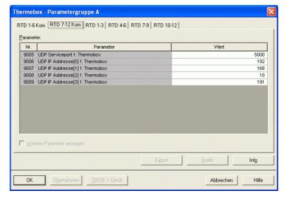
Im nächsten Schritt werden alle benötigten Messeingänge konfiguriert. Je nach Applikation werden in 2 bzw. 4 Einstellblättern je 6 Messeingänge zur Konfiguration angeboten.
