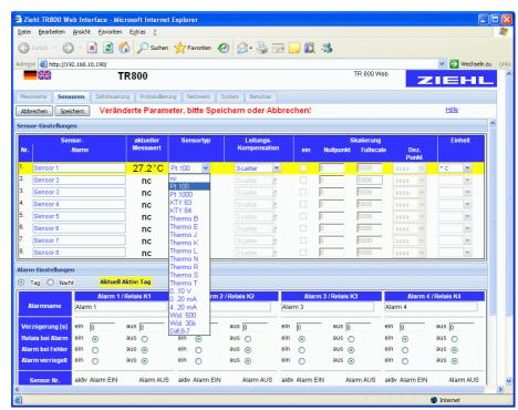
Die "3-Leiter" oder "Leitungs-Kompensation" für den 2-draht Betrieb in Ohm auswählen.
