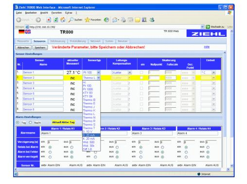
Soll der Messwert skaliert werden, bei "Skalierung", "ein" einen Haken setzen.
