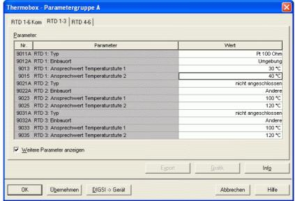
Wenn alle Messeingänge konfiguriert sind, werden die Einstellungen mit dem Button "DIGSI -> Gerät" zum Schutzgerät gesandt.
