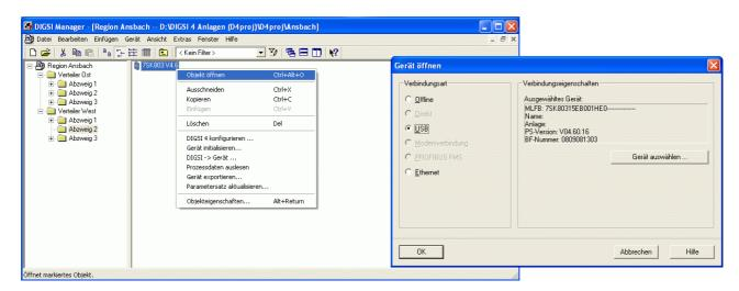
Im Fenster "Gerät öffnen" kann mit "Verbindungsart" - "USB" das Gerät ausgewählt werden, oder über "Ethernet" die Verbindung direkt hergestellt werden.
