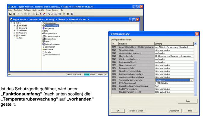
Die "RTD-Anschlussart" ist im Lieferzustand auf "6 RTD Simplex" eingestellt und muss für beide Applikationen entsprechend geändert werden.
