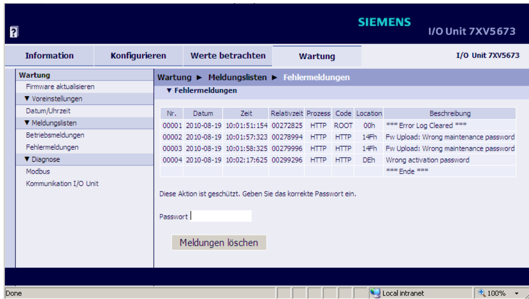
Bild 6-57 Registerkarte Wartung, Fehlermeldungen löschen
