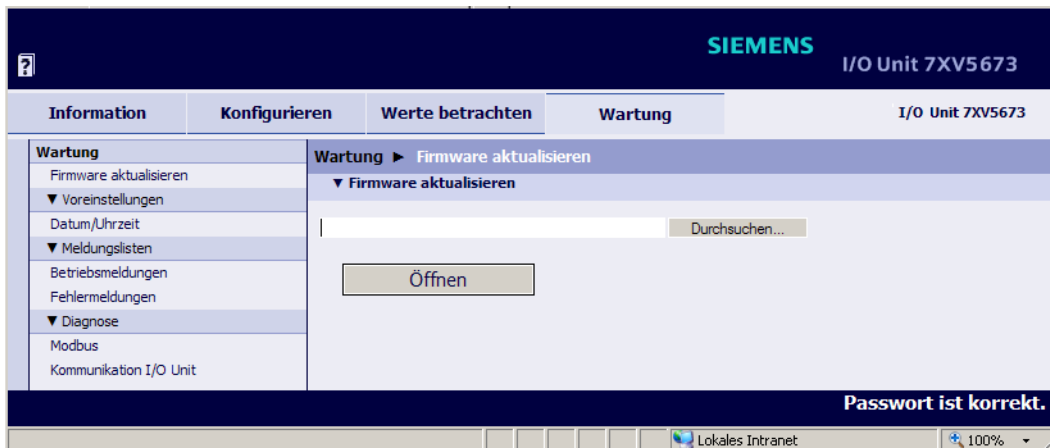
Bild 6-53 Registerkarte Wartung, Ein-/Ausgabefenster Firmware aktualisieren - Öffnen
