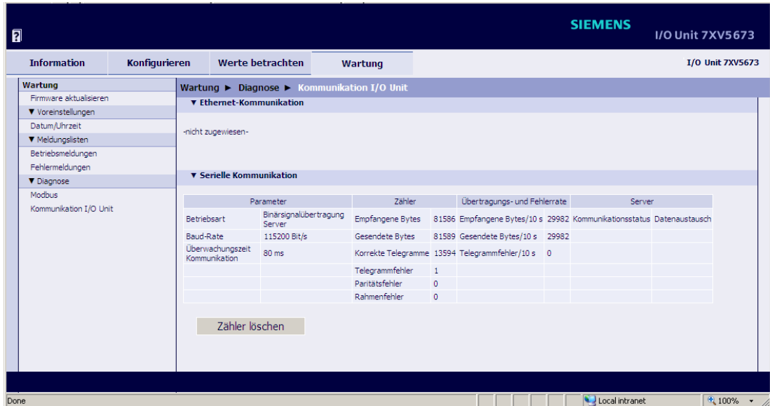
Bild 8-11 Diagnose Serielle Kommunikation - Binärsignalübertragung Server
