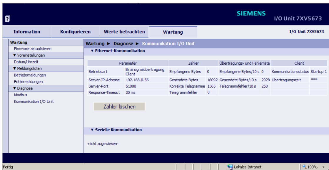
Bild 8-8 Diagnose Ethernet-Kommunikation - Binärsignalübertragung Client
