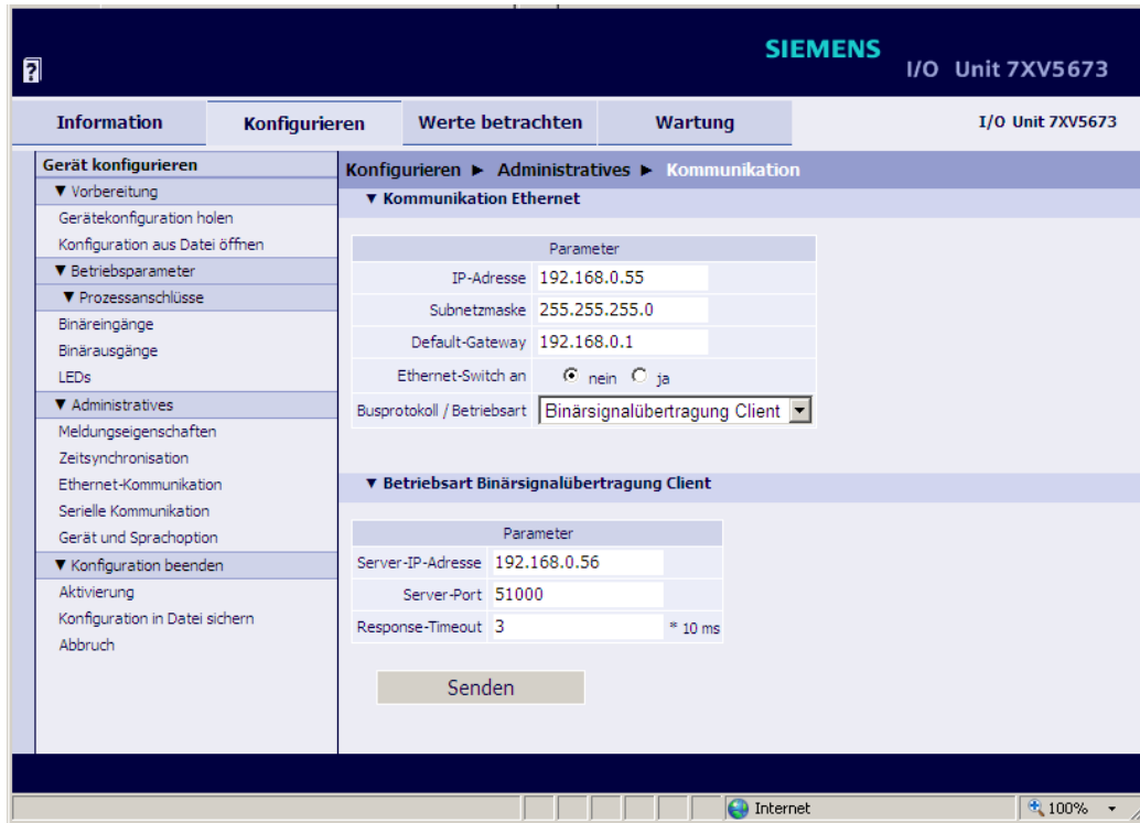
Bild 6-69 Einstellungen der Ethernet-Kommunikation für Binärsignalübertragung Client
