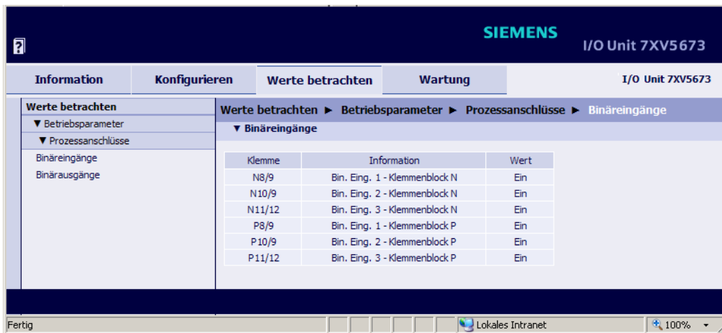
Bild 6-50 Registerkarte Werte betrachten, Binäreingänge
