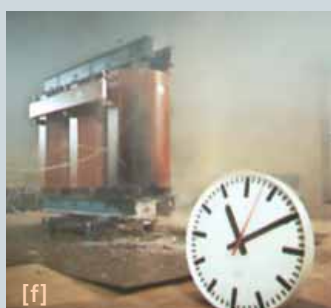
Bild 6: Brandablauf bei einer Beflammung mit Holzfeuer: Die Außenfläche der Oberspannungswicklung konnte nur im unmittelbaren Bereich des Stützfeuers zum Brennen gebracht werden, und der Brand wurde kaum zum Nachbarschenkel fortgeleitet.
