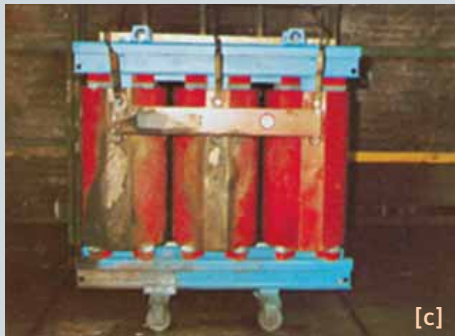
Bild 4: GEAFOLE-Gießharztransformator im Kurzschlusslichtbogenversuch: a) vor dem Versuch, b) während des Versuchs sowie c) nach dem Versuch.
