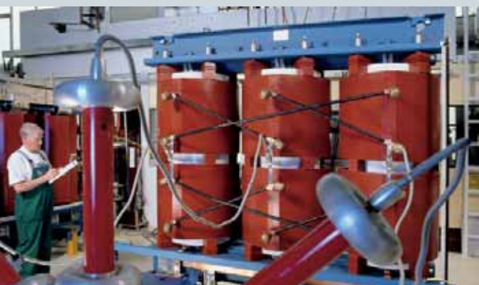
Bild 1: GEAFFOL-Gießharztransformator im Prüffeld des Siemens-Transformatorwerks in Kirchheim/Teck: Werden GEAFFOL-Gießharztransformatoren in einen Umgebungsbrand einbezogen, tragen sie mit ihrer geringen Brandlast nur unwesentlich zum Brandgeschehen bei. Auch durch Kurzschlusslichtbögen bei Eigenfehlern entzünden sich ihre Spulen nicht. Es entstehen auch keine über die brandüblichen Rauchgase hinausgehenden toxischen Anteile.
