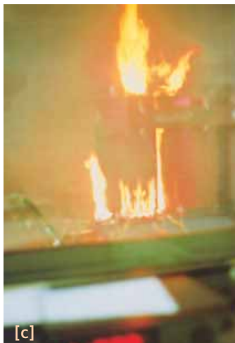
Bild 7: Brandablauf bei Beflammung mit Propangasfeuer. a) nach sechs Minuten c) nach 20 Minuten
