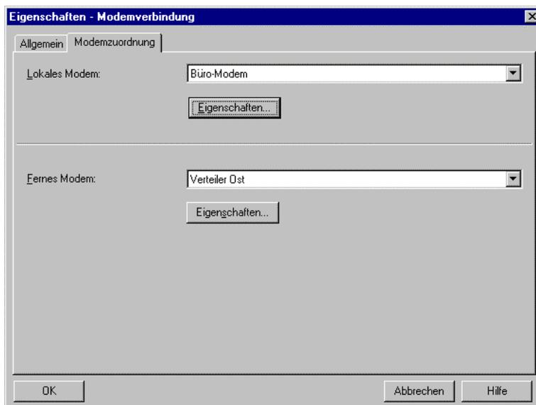
Alle Einstellungen in DIGSI 4 sind nun vollständig und das Büromodem kann über ein Modemkabel, das meist im Lieferumfang enthalten ist, mit dem Bedien-PC verbunden werden.
