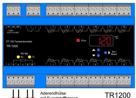
Anschluss der Thermobox 7XV5662-6AD10 mit Verbindungskabel 7XV5103-7AAxx am Schutzgerät SIPROTEC 4 (RS485)
