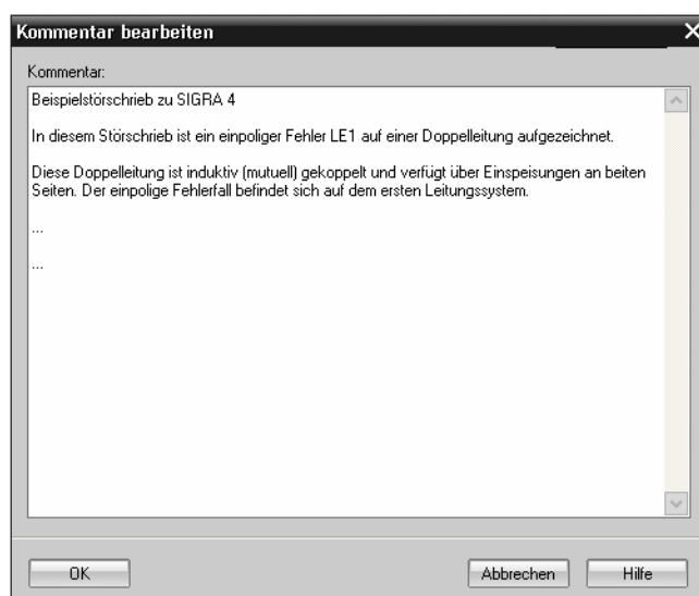
Bild 3-7 SIGRA 4, Ein Beispiel für die Kommentierung eines Störschriebes.
