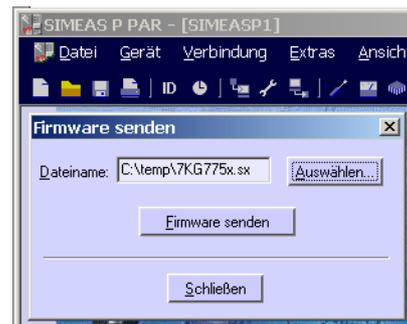
Drücken Sie den Button **Firmware senden**. Die Übertragung dauert einige Minuten.
