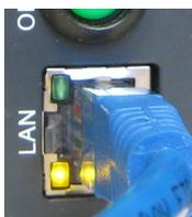
Am *LAN* Anschluss wird das *SIMEAS Q80 7KG8080* über Ethernet mit dem PC verbunden. Bei der Verbindung über ein lokales Netzwerk ist ein ungekreuztes Ethernet-Kabel zu verwenden, bei direktem Anschluss des Messgerätes an den PC wird ein gekreuztes Ethernet-Kabel benötigt.
