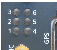
Am *SIMEAS Q80 7KG8080* befindet sich eine LED Doppelreihe mit 6 LED's. Diese LED's zeigen durch ihr Leuchten verschiedene Zustände an. Die LED's 3 und 4 sind z.Z. davon ausgeschlossen.
