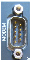
Über den neunpoligen DSUB Anschluss kann ein externes Modem (RS232) angeschlossen werden. Für den Modembetrieb muss das *SIMEAS Q80 7KG8080* als PPP-Server konfiguriert werden, siehe Systemhandbuch der Software *SIMEAS Q80 Manager*.
