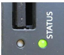
Die *STATUS* LED dient zur Signalisierung des derzeitigen Betriebszustandes des Gerätes. Direkt nach dem Einschalten blinkt sie wenige mal rot auf, geht dann in ein grünes Blinken über (dabei wird u.a. die Speicherkarte geprüft, ob eine Messaufgabe zum Starten vorhanden ist) und erlischt anschließend, was den Normalbetrieb signalisiert.
