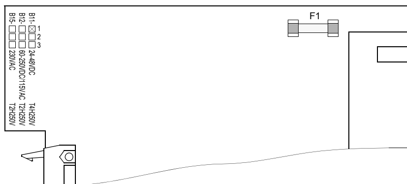
Bild 8-12 Feinsicherung der Stromversorgung der Prozessorbaugruppe CPU
