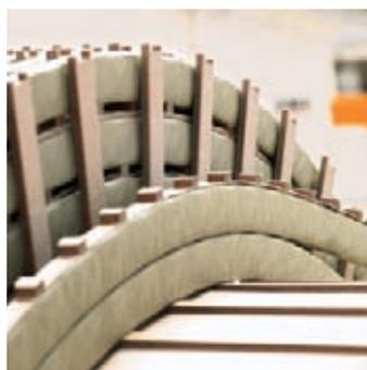
Una especialidad de la reparación en planta: la producción de bobinados de todo tipo.
