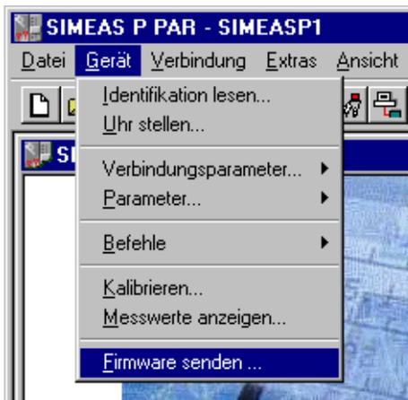
4. Nach dem Aufruf **Firmware senden** öffnet sich wieder ein kleines Fenster. In dieses geben Sie bitte den Pfad zur Firmware ein. Die Firmware hat die Bezeichnung 7KG7000.sx. Drücken Sie den Button **Firmware senden**: Der Vorgang kann einige Minuten dauern. Anschließend fragen Sie erneut die Identifikation ab (Button **ID**, siehe Punkt 2). Der neue Firmwarestand ist nun sichtbar.
