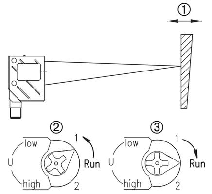
3. Para hacer el Teach, poner el interruptor giratorio en la posición «Run» (③). Esperar la confirmación óptica con el fin de la señalización intermitente (LED verde encendido).
