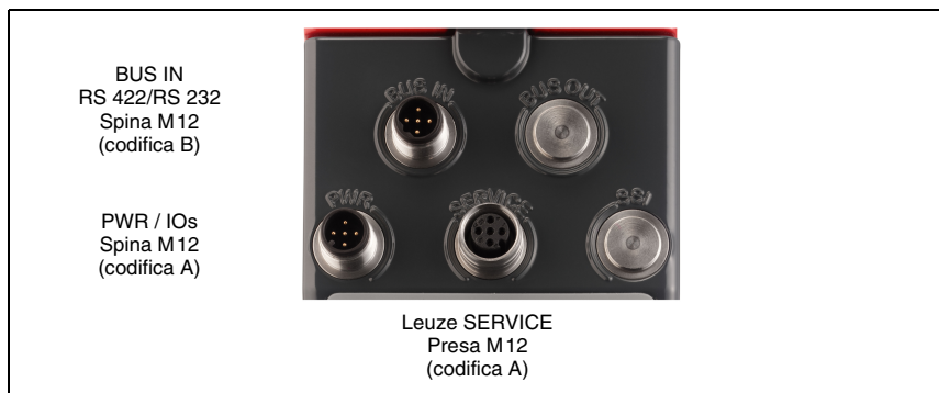
Figura 7.1: Collegamento del AMS 300 i
