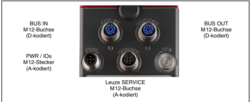
Bild 7.1: Anschlüsse des AMS 308 i
