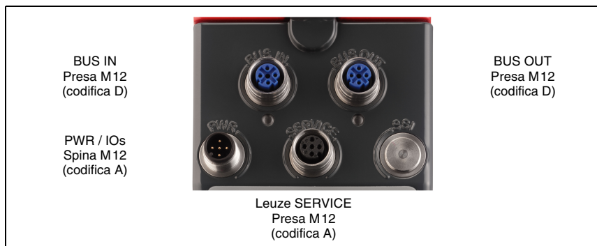
Figura 7.1: Collegamento del AMS 338 i
