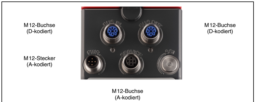
Bild 9.4: Anschlüsse des AMS 348 i
