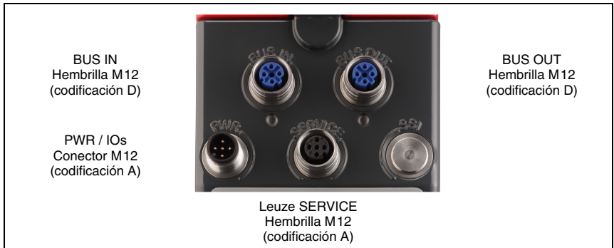
Figura 7.1: Conexiones del AMS 358 i
