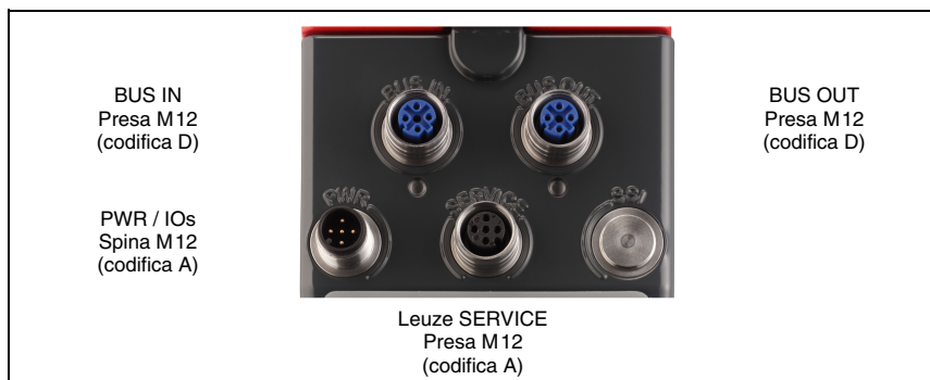
Figura 7.1: Collegamento del AMS 358 i
