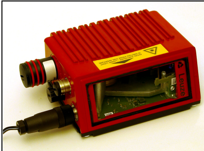
Figura 10.5: BCL 500i \ BCL 501i con memoria de parámetros montada
