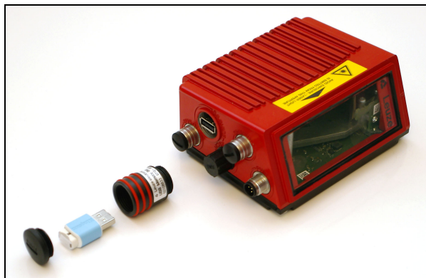
Figura 10.4: Montaje de la memoria de parámetros externa
