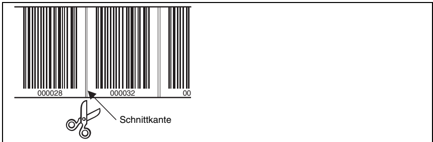
Bild 6.2: Schnittkante des Barcodebandes
