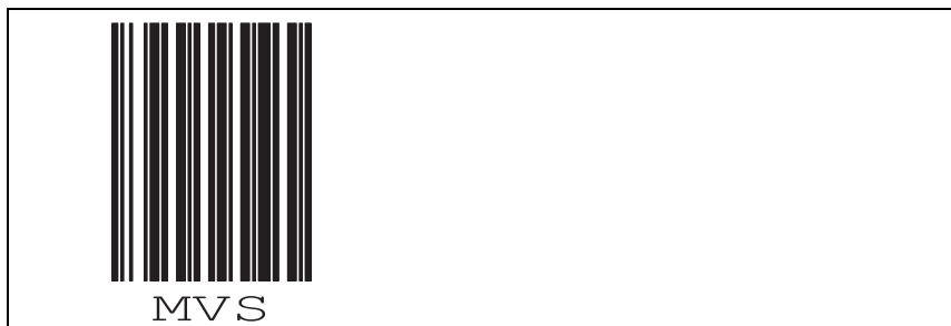
Рис. 6.7: Управляющий штриховой код MVS для переключения ленты
