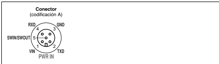
Figura 3.3: BPS 8 - asignación conector M12 PWR IN
