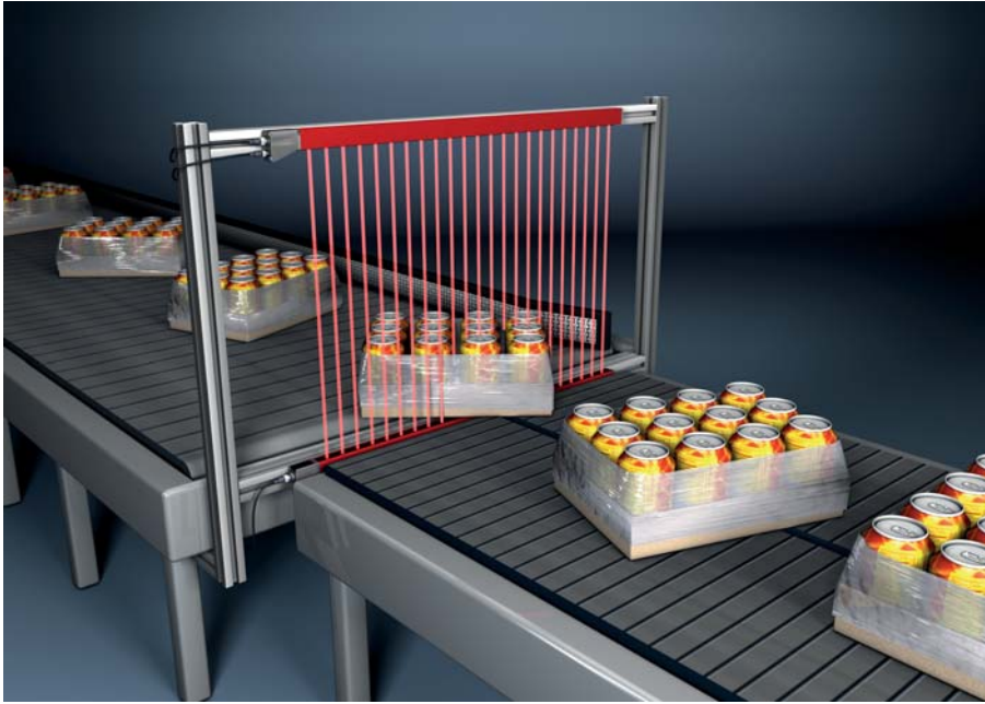
Figura 5.3: Medición de anchura
