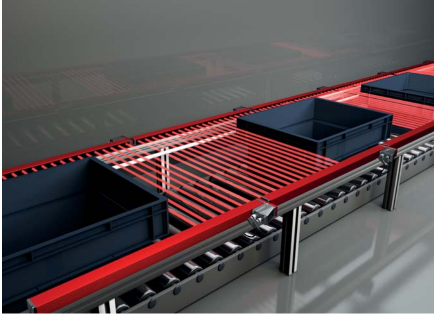
Figura 5.5: Control de espacios/medición de huecos
