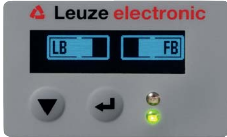
Figura 8.2: Visualización en el display de una cortina óptica con alineación óptima
