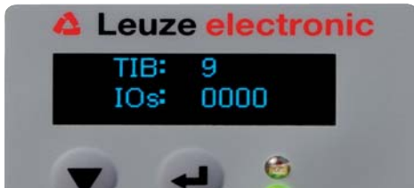
Figura 3.3: Display OLED en el receptor
