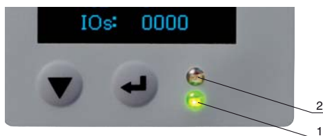
Figura 3.2: Indicadores LED en el receptor
