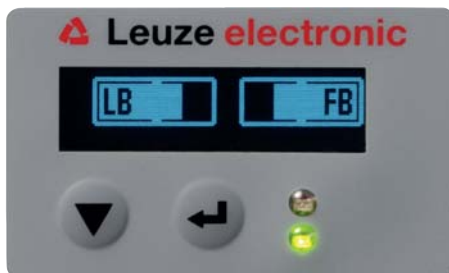
Figura 8.4: Representación del display después de un Teach realizado con éxito
