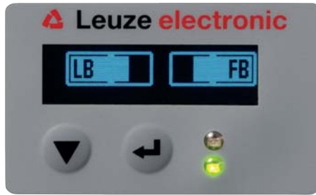
Figura 8.7: Representación del display después de un Teach realizado con éxito El siguiente paso de configuración es la comprobación de la alineación.
