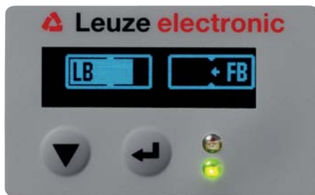
Figura 8.1: Ejemplo: Visualización en display de una cortina óptica con alineación incorrecta
