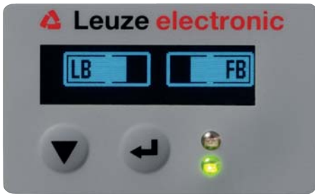
Bild 8.2: Displaydarstellung eines optimal ausgerichteten Lichtvorhangs
