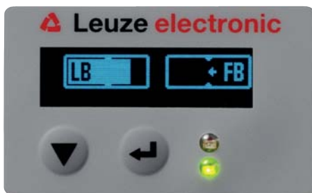
Bild 8.1: Beispiel: Displaydarstellung eines nicht richtig ausgerichteten Lichtvorhangs
