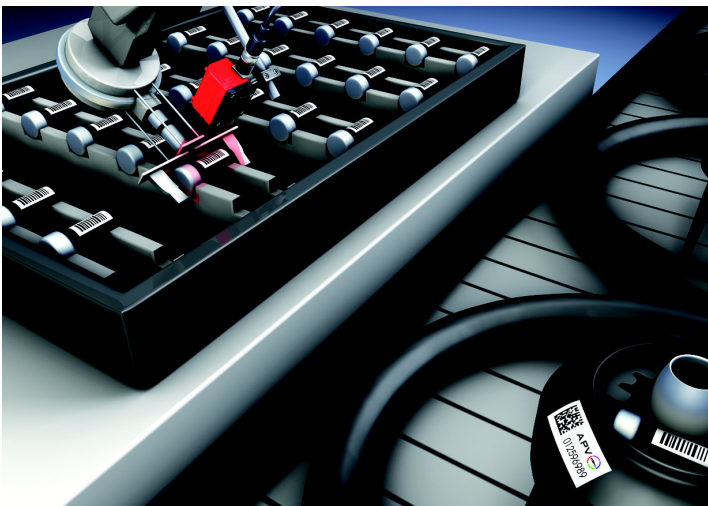
Bild 3.2: Applikationsbeispiel: Lesen von 1D-Codes in Handlingautomaten
