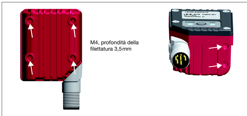
Figura 4.2: Possibilità di fissaggio mediante fori filettati M4x6
