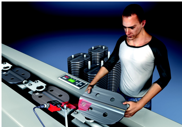
Figura 3.3: Esempio applicativo: lettura di codici 2D in modalità di presentazione
