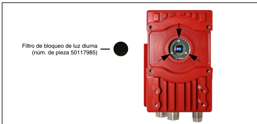
Figura 4.10: Cambio de filtro en equipos C-Mount
