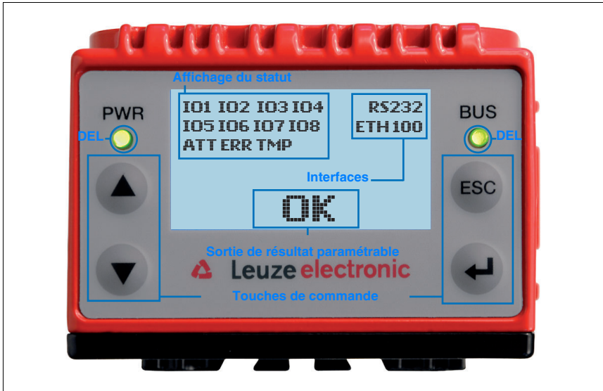
Figure 7.1 : Structure du panneau de commande
