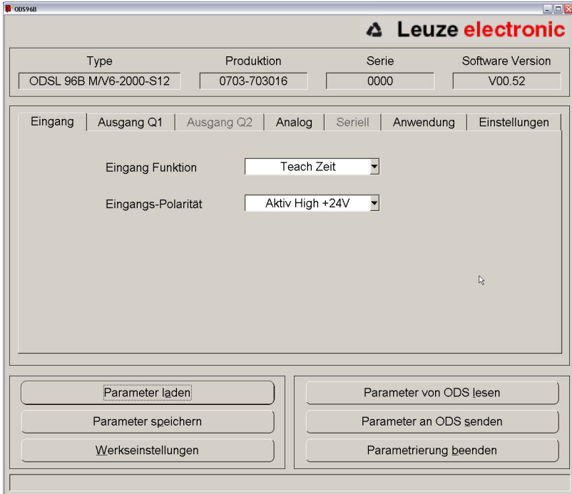
Bild 8.4: ODS 96B Konfigurationssoftware - Konfigurationsfenster
