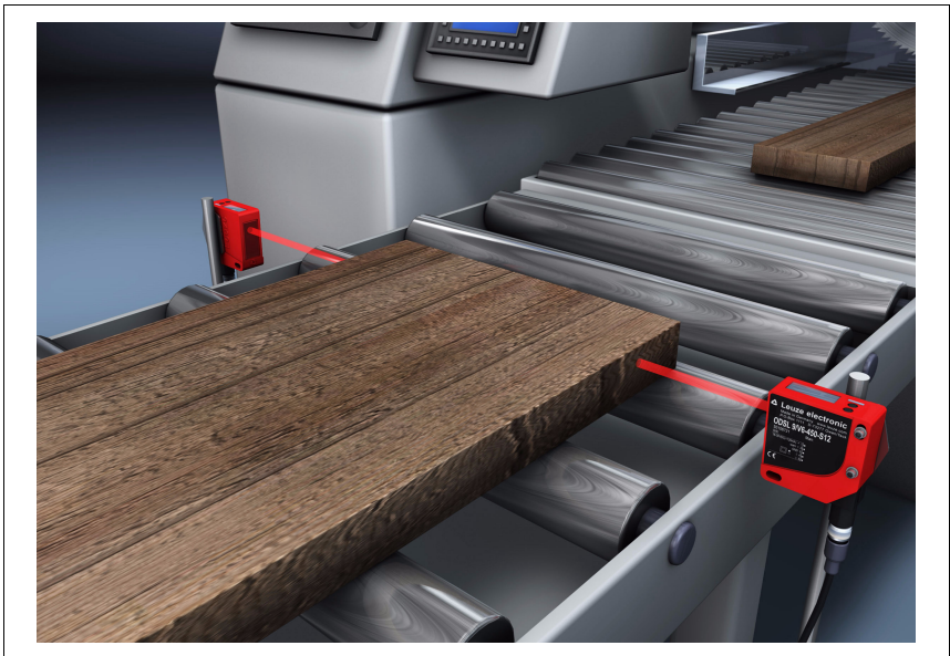
Bild 4.2: Applikationsbeispiel: Holz-Breitenvermessung mit dem ODSL 9
