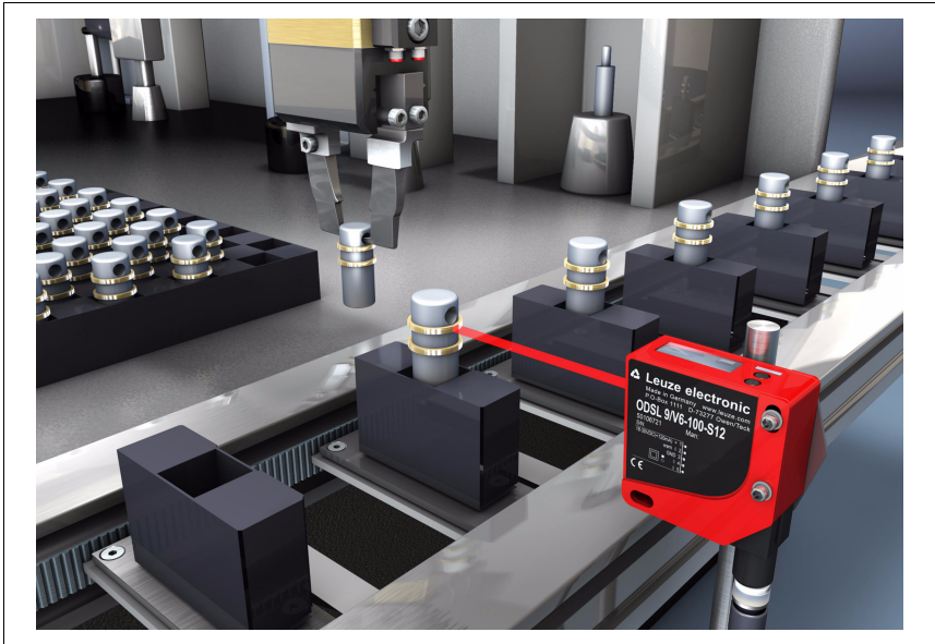
Bild 4.3: Applikationsbeispiel: Montagekontrolle mit dem ODSL 9
