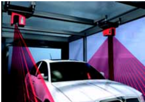
Figure 3.8 : Exemple d'application - Parking automatique
