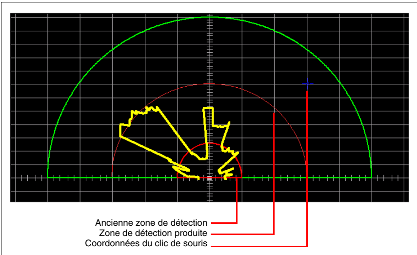
Fig. 6.7 : Positionnement d'une zone de détection en « Ellipse »
