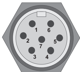
Bild 7.4-2: Empfänger/Transceiver Maschinen-Interface /T3, MIN-Series Stecker (Blick auf die Stifte)
