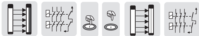
Bild 4.2-3: Schützkontroll-Funktion, im Beispiel kombiniert mit Anlauf-/Wiederanlaufsperr
