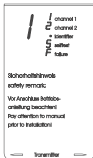
Fig. 5.1-1: Indicadores de funcionamiento del emisor
