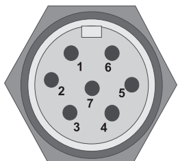
Fig. 7.4-2: Receptor/transceptor interfaz de máquina /T3, conector MIN-Series (vista de los pines)
