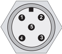
Fig. 7.9-1: Interface émetteur /AP, socle connecteur M12 à 5 points (vue sur les broches)
