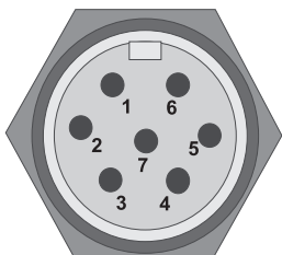
Fig. 7.4-2: Récepteur/émetteur-récepteur (transceiver), interface machine /T3, connecteur MIN-Series (vue sur les broches)
