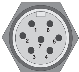
Fig. 7.4-2: Interfaccia del ricevitore/transceiver verso la macchina /T3, connettore MIN-Series (vista sui pin)
