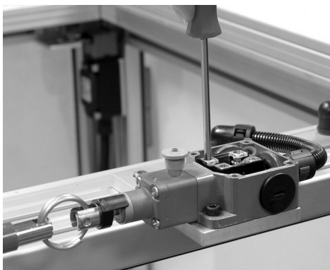
Figura 7.5: Esempio di collegamento ERS200-M1C3-M20-HLR
