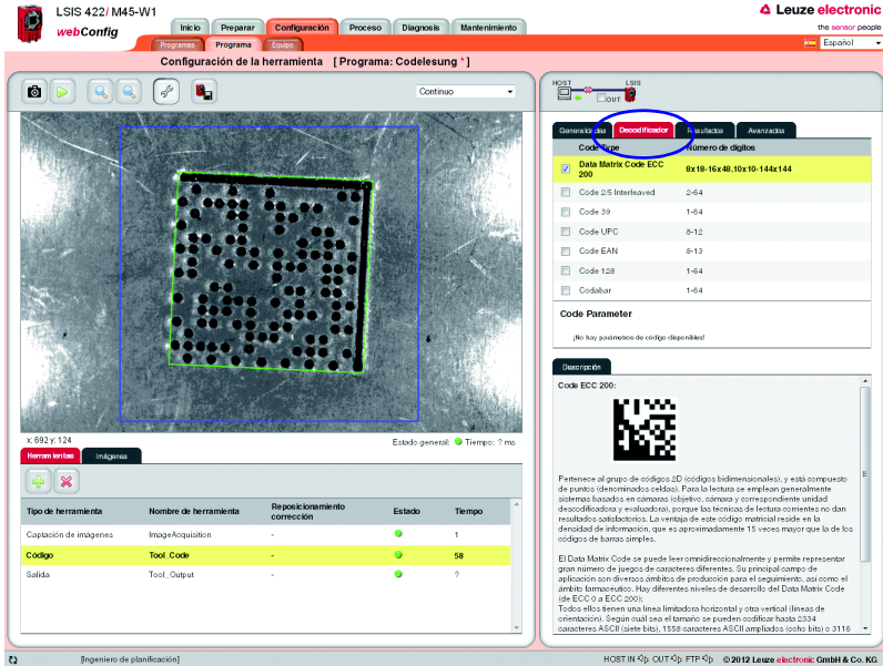
Figura 4.17: Grupo de parámetros «Decodificador» – Desactivar códigos no necesarios
