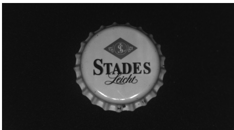
Figura 4.36: Alineación oblicua de la cámara, solo hay 3 cuadrantes de iluminación activos (el cuadrante reflectante está apagado), casi todas las reflexiones en la imagen están suprimidas
