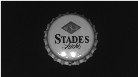
Fig. 4.35 : Caméra inclinée avec les 4 quadrants d'éclairage actifs : mieux, mais des réflexions sont encore présentes sur l'un des quadrants
