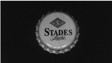
Fig. 4.36 : Caméra inclinée avec seulement 3 quadrants d'éclairage actifs (extinction du quadrant causant les réflexions) : presque toutes les réflexions sont éliminées de l'image
