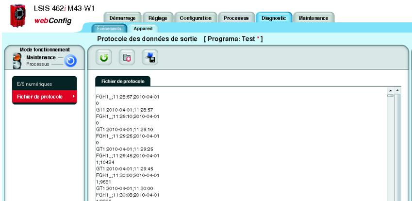
Fig. 3.52 : Affichage des données de sortie dans le fichier de protocole
