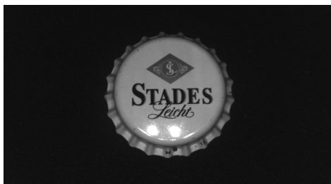
Bild 4.35: Allineamento obliquo della smart camera, sono attivi tutti e 4 i quadranti di illuminazione – il risultato è migliore, ma sono ancora visibili le riflessioni di un quadrante
