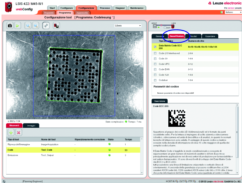
Bild 4.17: Gruppo di parametri «Decodificatore» – disattivare i codici non necessari
