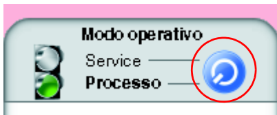
Bild 3.2: Commutazione del modo operativo tramite pulsante o selezionando una voce di menu
