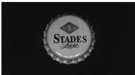
Bild 4.36: Allineamento obliquo della smart camera, sono attivi solo 3 quadranti di illuminazione (il quadrante riflettente non è attivo) – quasi tutte le riflessioni nell'immagine sono soppresse
