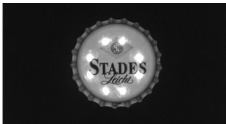
Bild 4.57: Senkrechte Kameraausrichtung – maximale Reflexionen
