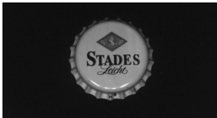
Bild 4.59: Schräge Kameraausrichtung, nur 3 Beleuchtungsquadranten aktiv (reflektierter Quadrant ist aus) – fast alle Reflexionen im Bild unterdrückt
