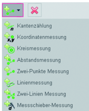
Bild 3.39: Parameter "Messen" des Messen-Tools / unterstützte Messvorschriften
