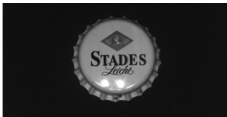
Bild 4.58: Schräge Kameraausrichtung, alle 4 Beleuchtungsquadranten aktiv – besser, aber noch Reflexionen eines Quadranten sichtbar
