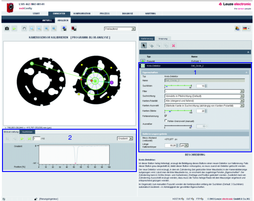
Bild 3.12: Register "Kalibrierung" - Eigenschaften Kreis-Detektor / Register "Suchlinien"
