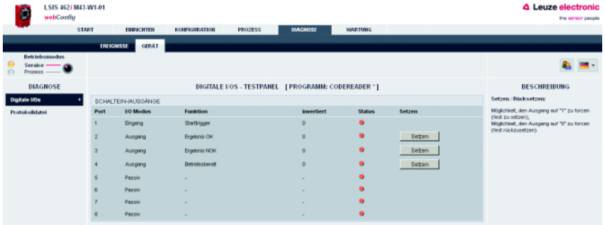
Bild 3.67: Modul "Diagnose", Register "Gerät" -Digitale I/Os
