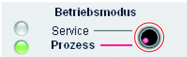
Bild 3.2: Umschalten des Betriebsmodus per Button oder Anwahl eines Menüeintrages
