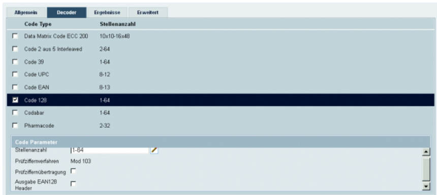
Bild 3.28: Decoder Parameter des Code-Tools
