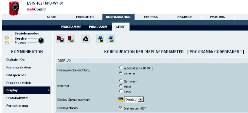
Bild 3.59: Modul "Konfiguration", Register "Gerät" – Display
