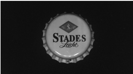
Bild 4.36: Schräge Kameraausrichtung, nur 3 Beleuchtungsquadranten aktiv (reflektierter Quadrant ist aus) – fast alle Reflexionen im Bild unterdrückt
