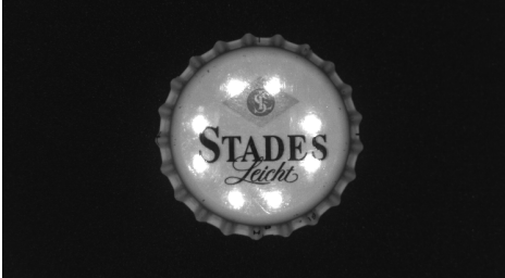
Bild 4.34: Senkrechte Kameraausrichtung – maximale Reflexionen
