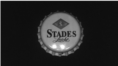
Bild 4.35: Schräge Kameraausrichtung, alle 4 Beleuchtungsquadranten aktiv – besser, aber noch Reflexionen eines Quadranten sichtbar
