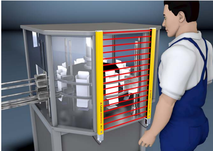
Ilustração 5.1: Resgare as proteções de acesso a pontos de perigo ao intervir na zona de perigo, por exemplo, no caso de uma máquina de cartonagem e sistemas de enchimento
