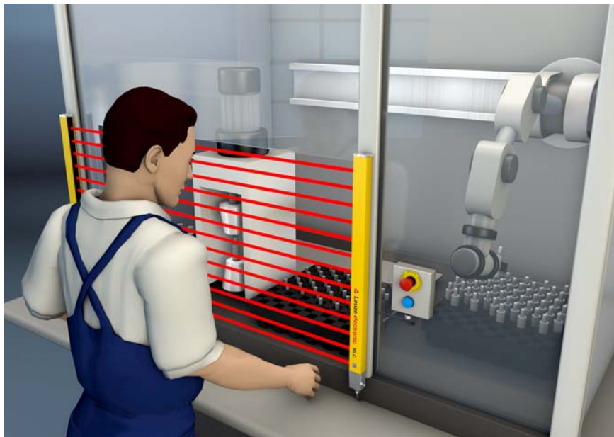
图片 5.2: 安全传感器防止进入危险区域如取放机器人
