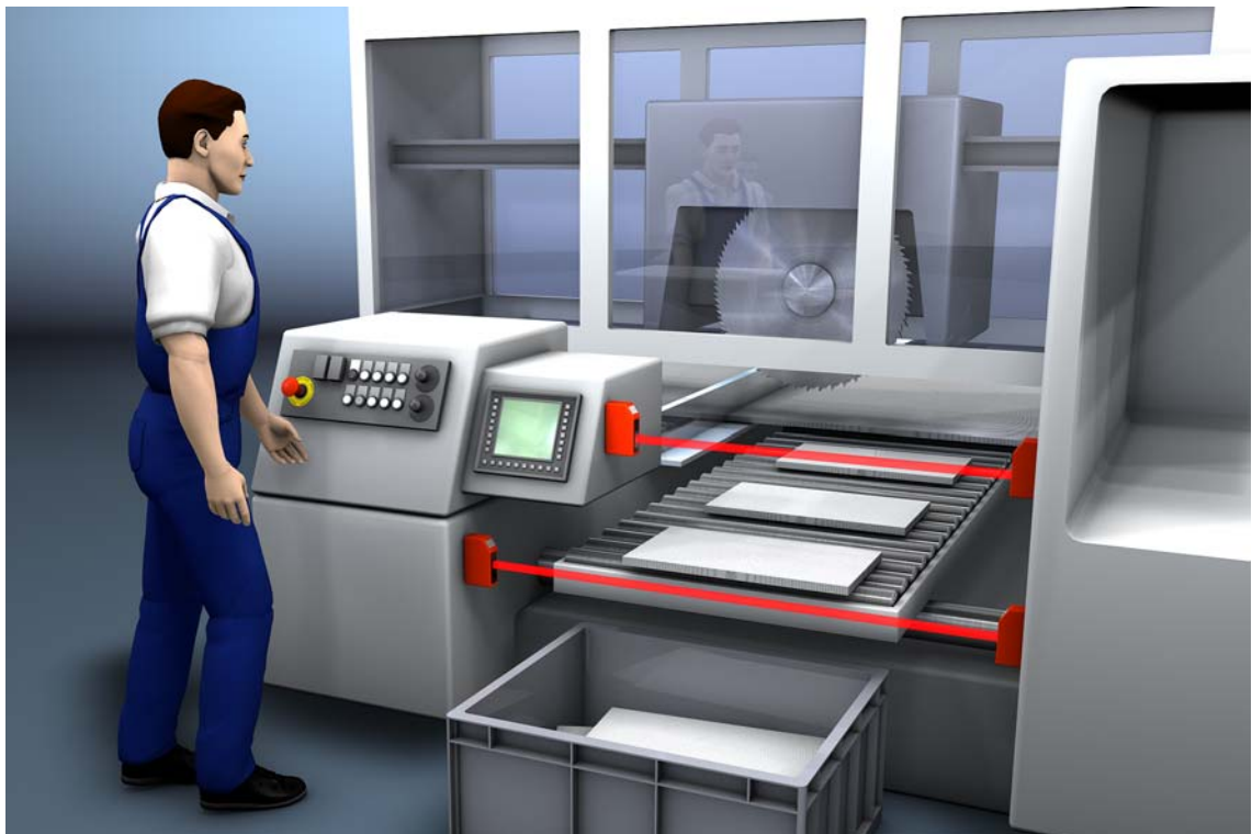
Bild 5.2: Zugangs-/Eingreifsicherung an Sägemaschine
