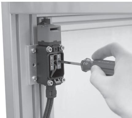
↪ Fijar la tapa de la carcasa con 0,8–1,2Nm.
