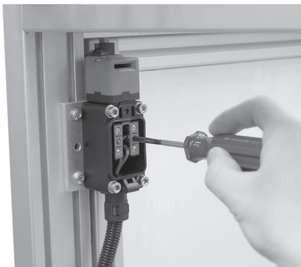
Figure 7.5: Exemple de branchement pour le S200-M3C1-M20
