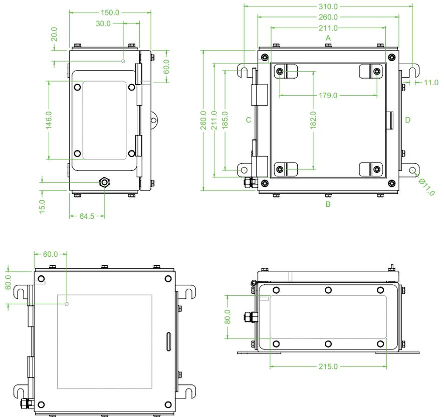
Abbildung/Maßzeichnung zeigt Version mit 4 Flanschplatten.
